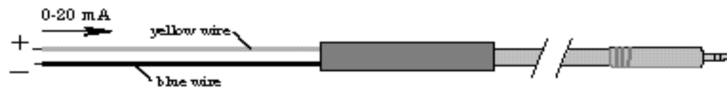
Diagram A - 4-20 mA Input cable
